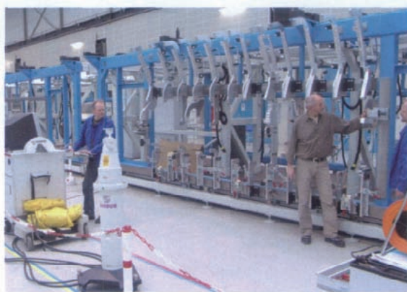
图1 空客不来梅工厂机翼装配工装的检测
