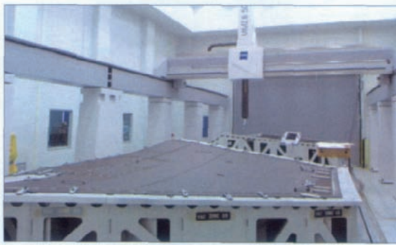
图3 Zeiss MMZ测量机检测F-35复材壁板
