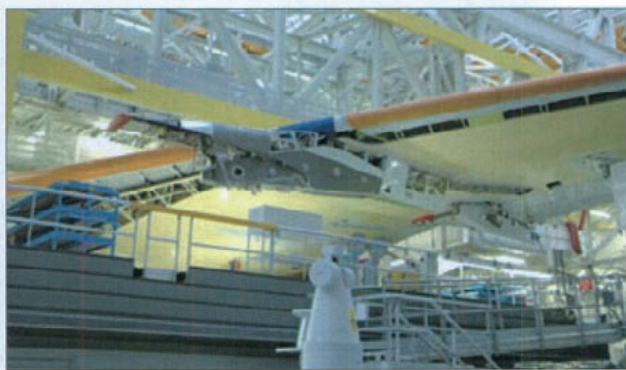
图5 基于激光测量的A380装配站
