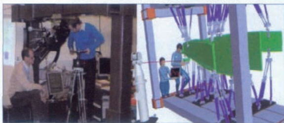
图2 Leica T-Mac引导柔性夹具定位的工程案例
